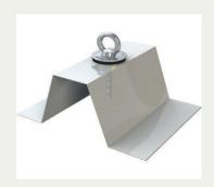
Der mit Kippdübeln montierte Edelstahl-Anschlagpunkt Lock VI kommt mit einer zusätzlichen Funktion: Nutzen Sie diese Anschlageinrichtung alternativ auch als Verankerungspunkt für Personensicherungsnetze. Das System ist für Sandwich- und Trapezbleche (positiv/negativ) geeignet. Bei Stahluntergründen genügt eine Stärke ab mindestens 0,75mm zur Montage. Aluminiumuntergründe sollten eine Stärke von 1,5mm aufweisen. Die Kippdübel haben eine integrierte Isolierung.
