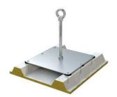
Der Edelstahl-Anschlagpunkt (Ø 16mm) ABS-Lock X-T-ALU bietet zuverlässigen Halt auf Trapez- und Sandwichblechen aus Aluminium mit einer Mindeststärke von 0,7 mm. Befestigt wird die Anschlageinrichtung mit einer Grundplatte von 370 x 370 mm und 6 Spezialkippdübeln komplett von oben. Auf Anfrage liefern wir Ihnen diesen Anschlagpunkt gerne in alternativen Grundplattengrößen
