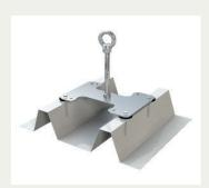
Die Anschlageinrichtung ist für positiv und negativ verlegte Trapezbleche konzipiert. Sie kann als Einzelanschlagpunkt ebenso eingesetzt werden wie als Halterung für Seilsicherungskomponenten. Befestigt wird die Sicherungslösung mit 4 Kippdübeln, die zum Lieferumfang gehören.
