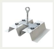
Mit dem Lock X-T-21 reduzieren Sie den Montageaufwand Ihrer Absturzsicherung. Der Anschlagpunkt wird mit 4 vormontierten Kippdübeln geliefert, die Sie ganz bequem einzeln von oben durch die Löcher der Grundplatte (290 x 200 mm) stecken. Die Absturzsicherung für Warmdächer bietet 3 Personen eine zuverlässige Anschlagmöglichkeit, die als Rückhaltesystem und Auffangvorrichtung genutzt werden kann.
