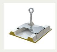
Mit dem Lock X-SW haben Sie eine Absturzsicherung für Sandwichdächer zur Hand, die unkompliziert von oben montiert wird. Dafür bohren Sie einfach 4 Löcher, entfernen mit einem Schraubendreher (o. ä.) etwas von der Dämmung unter der Dachhaut und stecken die Kippdübel hinein. Voraussetzung für die Montage des Anschlagpunt ist eine Mindeststärke der Sandwichprofile (Stahl) von 0,5 mm.
