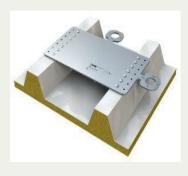
Gleich 2 Anschlagmöglichkeiten bietet der speziell für Container entwickelte Lock X-Flat. Der Personen-Anschlagpunkt wird mit 14 wasserdichten Blindnieten komplett von oben installiert. Weil er nur wenige Millimeter stark ist, können Sie die Container auch nach der Montage der Absturzsicherung wie gewohnt stapeln.
