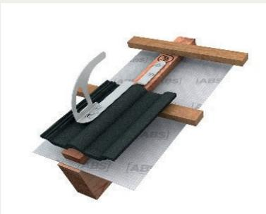
Lock DH04 OG hat einen gekröpften Holm zur Überbrückung der Dachlattung. Er wird mit 2 Edelstahlschrauben durch die Konterlattung im Sparren festgemacht. Für 3 Personen zugelassen
