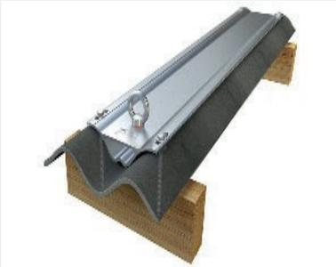
Diese spezielle Anschlageinrichtung für Wellplattendächer kann bereits ab einer Sparrenbreite von 60 x 120 mm verbaut werden. Der Lock Wave 60 hat eine 125 cm lange Grundplatte und wird mit vier Schrauben an zwei Sparren befestigt. Die ausgelieferte Standardlänge ist dabei auf einen Sparrenabstand (Balkenmitte bis Balkenmitte) von 115 cm ausgelegt.
