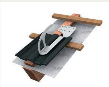
Eine Grundplatte mit 12 Bohrlöchern macht die Montage des Lock DH05 besonders flexibel. Der Dachhaken wird mit nur 2 Schrauben im tragenden Balken verschraubt und so ausgerichtet, dass er perfekt in die Wölbung der Ziegel passt.
