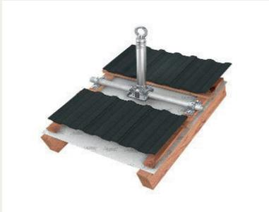
Lock SD für Holzsparren wird mit einem Querrohr an 2 Sparren verschraubt. Das Querrohr ermöglicht eine stufenlose Ausrichtung des Anschlagpunkt an jeden Neigungswinkel Ihres Steilaches. Die Stütze der Anschlageinrichtung ist standardmäßig mit einem Stützrohr (Ø 42mm) verstärkt und kann daher als beliebige Komponente in einem Seilsicherungssystem eingesetzt werden. Zugelassen für 3 Personen
