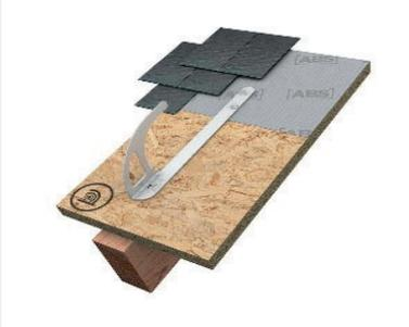
Lock DH04-F wird gemäß DIN EN 517:2006, Typ B als Anschlagmöglichkeit in jede Belastungsrichtung genutzt. Der Vorteil:- Sicherheitsdachhaken nach DIN EN 517:2006, Typ B. Der Edelstahl-Dachhaken verfügt über einen flachen Holm für durchgängige Schalungen. Er wird mit 2 Edelstahlschrauben durch die Konterlattung/Schalung (Aufsparrendämmung) im Sparren befestigt. Der tragende Balken muss dabei mindestens 60 mm x 120 mm stark sein
