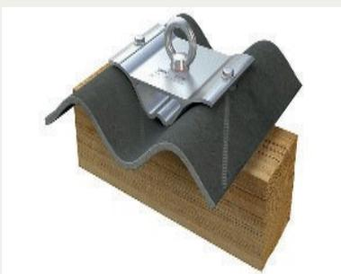
Lock Wave ist ein Edelstahl-Anschlagpunkt mit einer wellenförmigen Aluminiumgrundplatte. Er fügt sich optimal in die Profile von Wellplattendächern (etwa der Marke Eternit) mit einem Wellenabstand von 177 mm. Montieren Sie diese Anschlageinrichtung mit nur 2 Schrauben direkt im Dachsparren: Dabei genügt eine Mindeststärke von 100 x 120 mm.
