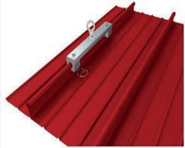
Lock Falz V für Rundbördelfalze sorgt mit seiner frei drehbaren Anschlagöse für Bewegungsfreiheit auf dem Metallfalzdach. Die Absturzsicherung wird mit Spezial-Aluminiumklammern durchdringungsfrei auf dem Rundbördelfalz (z.B. BEMO, KalZip etc.) festgeklemmt.
