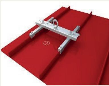
Lock Falz IV Stehfalz die Lösung. Der Anschlagpunkt wird auf dem Stehfalz festgeklemmt und ist für Dächer mit Falzabständen von 300 bis 660 mm verfügbar (z.B. Rheinzink). Der Vorteil: Die speziellen Aluminiumklemmen durchdringen die Dachhaut nicht, das Dach bleibt daher dicht.
