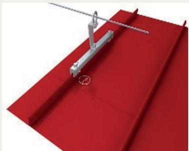
Der Lock IV Stehfalz ZW wird mit Aluminiumklemmen befestigt, die passende Profile für Stehfalze besitzen. Die Klemmen ermöglichen Ihnen eine Montage, ohne die Dachhaut beschädigen zu müssen. So wahren Sie die Dichtigkeit und errichten zugleich eine zuverlässige Anschlageinrichtung für mehrere Personen auf dem Metallfalzdach
