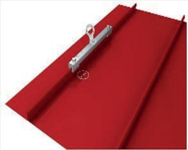
Lock Falz V wird auf dem Stehfalzdach auf nur 1 Schar festgeklemmt und sorgt für besonderen Bedienkomfort: Seine Edelstahlöse ist frei um 360° drehbar. Die Anschlagereinrichtung ist für Stehfalzdächer verschiedener Hersteller geeignet, z.B. Rheinzink oder ähnliche Systeme.
