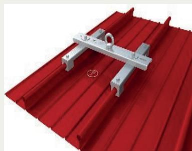
Lock Falz IV ist auch für Rundbördelfalze verfügbar. In dieser Variante ist der Anschlagpunkt z. B. für BEMO, KalZip und ähnliche Dachtypen geeignet. Herz des Einzelanschlagpunkts sind seine Spezialklemmen - das einzige Bauteil, das nicht aus Edelstahl, sondern aus ebenso hochwertigem Aluminium hergestellt ist. Diese Klemmen sitzen passgenau auf den Rundbördeln der Dachhaut.
