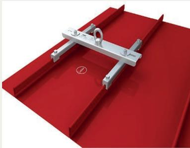
Lock Falz IV Klip wird einfach auf die Metallfalze (z. B. KlipTec, Snapfalz etc.) geklemmt und sichert 3 Personen gegen Absturz. Möglich wird das mit speziellen Aluminiumklemmen, die eine Öffnung der Dachhaut unnötig machen. Nach fachgerechter Fixierung der Klemmen sitzt der Anschlagpunkt fest auf der Dachhaut.
