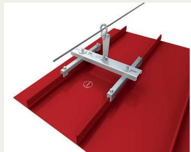
Falz IV Klip ZW ist ein Stützelement zur Errichtung von Seilsicherungssystemen auf Metallfalzdächern. Seine Spezialklemmen werden direkt auf die Schare geklemmt, sodass die Dachhaut nicht durchdrungen wird. Diese Systemkomponente ist in 2 Varianten erhältlich: Für Falzabstände von 300 bis 450 mm und für Abstände von 420 bis 660 mm.
