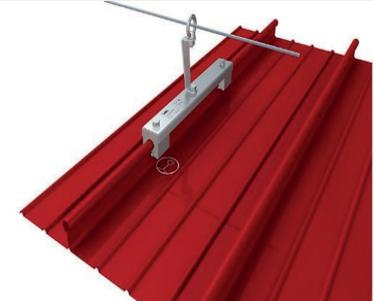
Lock Falz IV Rundbördelfalz ZW führen Sie das Edelstahl-Seil Ihres Seilsicherungssystems über Hindernisse. Der Zwischenhalter wird beispielsweise eingesetzt, um das Seil über den erhöhten Dachfirst zu führen, sodass es nicht aufliegt.
