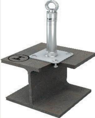
Lock X-SR-ST sitzt auf einer Edelstahl-Grundplatte und ist somit bestens für die Verwendung als tragendes Element in Seilsicherungssystemen geeignet. Die Grundplatte wird mit 4 Schrauben und Muttern durch Stahlunterkonstruktionen gekontert und hält der Vorspannung in Seilsicherungssystemen problemlos stand. Dank der variablen Stützenhöhe können Sie das Seilsicherungssystem sehr flexibel nach Ihren Bedürfnissen planen
