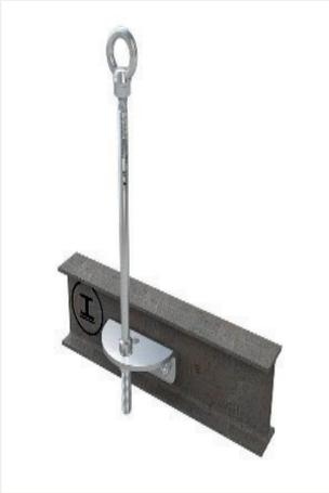
Lock III-Seitl-65 für die seitliche Montage auf Stahl. Er eignet sich damit besonders für verschiedene Anwendungsfelder der Industrie. Der Edelstahl-Anschlagpunkt ( $\varnothing$  16mm) wird mit einer Winkelplatte befestigt. Diese wird durch den Untergrund gekontert, beispielsweise durch tragende Stahlträger. Das erforderliche Befestigungsmaterial gehört zum Lieferumfang.
