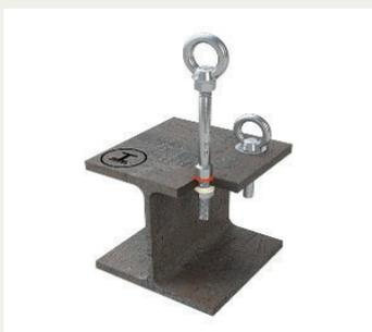
Eine 16mm starke Edelstahlstütze ist das Herz der Anschlageinrichtung Lock III-ST. Der Anschlagpunkt kann in jede Richtung belastet werden, sichert bis zu 3 Personen bei Höhenarbeiten und ist auf Wunsch auch ohne Überstand lieferbar
