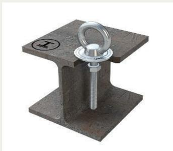
Der Edelstahl-Anschlagpunkt Lock IV-ST für Stahl bietet Ihnen 2 Montagevarianten: Er wird entweder mit einer Mutter gekontert oder direkt in ein bauseitig vorhandenes Gewinde (M12) geschraubt. Unabhängig davon, für welche Installation Sie sich entscheiden, kann die Anschlageinrichtung in jede Belastungsrichtung genutzt werden.
