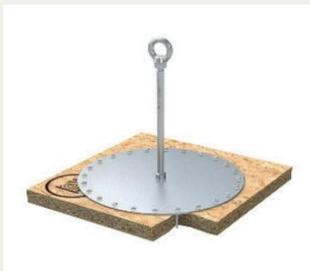
Ein Anschlagpunkt für 3 Personen, der schon auf OSB (Grobspanplatten) ab 12 mm Stärke hält? Für den Lock X-H-24 ist das dank seiner Grundplatten-geometrie kein Problem. Der komplett aus Edelstahl gefertigte Anschlagpunkt wird mit 24 Schrauben auf Untergründen aus OSB-Platten oder auf Holzschalungen verschraubt
