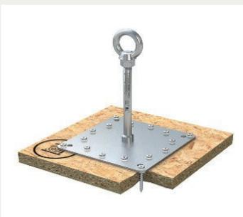
Absturzsicherung auf Holz mit nur 24 mm Stärke? Für den ABS-Lock X-H-16 ist das kein Problem. Der Einzelanschlagpunkt kann auf OSB sogar schon ab einer Mindeststärke von 18mm (22 mm nach abZ Vorgabe) montiert werden. Möglich wird das durch seine verformbare Edelstahl-Stütze, die bei einem Sturz die Hebelkräfte in Schubkräfte umwandelt.
