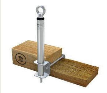
Der Edelstahl-Anschlagpunkt Lock III-SEITL-SR mit Stützrohr ( $\varnothing$  42mm) kann auf verschiedene Arten als Komponente in Seilsicherungssystemen verwendet werden. Die Befestigung auf Holzuntergründen erfolgt mit einer Winkelplatte, die durch tragende Balken (Sparren) gekontert wird. Durch das zusätzliche, verschraubte Stützrohr gibt der Anschlagpunkt der bei Seilsicherungssystemen notwendigen Vorspannung nicht nach.
