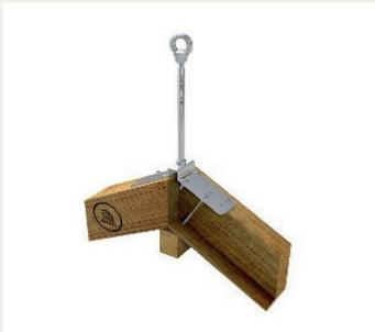
Lock X-First II heißt unser Edelstahl-Anschlagpunkt für den Dachfirst. Die Absturzsicherung ist praktisch, und das sowohl hinsichtlich der Montage als auch in der Anwendung. Die variable Grundplatte des Anschlagpunkt wird von Hand an jede Dachneigung angepasst und dann einfach mit 8 Schrauben im Dachsparren verschraubt. Und weil der Anschlagpunkt zentral auf dem First befestigt ist, dient er auf beiden Dachhälften als Absturzsicherung.
