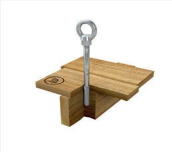
Unkomplizierter geht es kaum: Für den Einbau des Lock III-H bohren Sie einfach ein Loch. Dann schrauben Sie das untere Gewinde des Anschlagpunkts direkt in den Sparren. Nach der Montage sichert die Anschlageinrichtung bis zu 3 Personen gegen Abstürze - als Rückhaltesystem oder als Auffangsystem auf Ihrem Flachdach.
