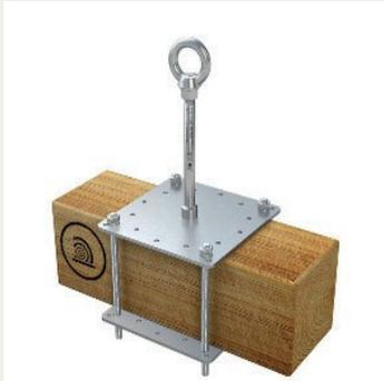
Sie wollen einen Einzelanschlagpunkt an einem Holzbalken befestigen, ohne diesen zu beschädigen? Dann ist der ABS-Lock X-Klemm die richtige Lösung. Die Anschlagereinrichtung aus Edelstahl wird mit einer Grund- und einer Konterplatte (je 200 x 200 mm) um tragende Sparren geklemmt.
