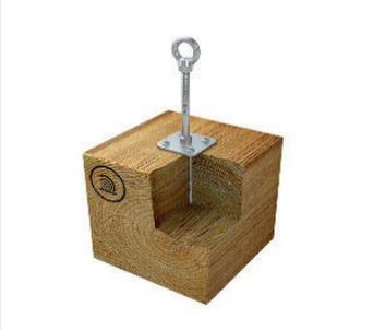
Die Anschlagereinrichtung Lock X-H-4 wird mit den 4 beigefügten Edelstahl-schrauben direkt im tragenden Balken verschraubt. Die Stütze des Anschlagpunkts hat einen Durchmesser von 16 mm, die Grundplatte ist 100 x 100 mm groß. Die Absturzsicherung ist ausschließlich für eine Querbelastung konzipiert und hält 3 Personen.
