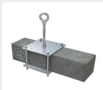
Eine starke Stütze, auch über Kopf - der Anschlagpunkt Lock X-Klemm wird mit seiner Grund- und Konterplatte um Betonträger geklemmt. Fachgerecht montiert sichert er bis zu 3 Ihrer Mitarbeiter zeitgleich, und das in jede Richtung. Durch diese Eigenschaften ist die Anschlageinrichtung sehr flexibel einsetzbar. Am Boden, an der Wand und an der Decke.
