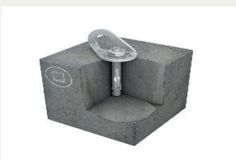
Der Lock V-B ist eine Anschlagvorrichtung für 1 Person. Mit einer dezenten Anschlaglasche ist diese Absturzicherung sehr unauffällig und stört die Architektur kaum. Der kompakte Anschlagpunkt wiegt kaum 40g, der mitgelieferte Einschlagdübel (M10) ermöglicht eine sehr unkomplizierte Befestigung im Beton.
