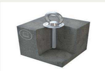
Der Lock IV-B ist ein kleines Multitalent. Trotz der geringen Maße ist diese optisch unauffällige Anschlagvorrichtung in alle Richtungen belastbar und für die Montage über Kopf geeignet. Der Edelstahl-Anschlagpunkt (Gewinde M12) wird mit unserem Verbundmörtel direkt im Beton befestigt. Nach Aushärtung des Zweikomponentenmörtels sichert der Anschlagpunkt 1 Person gegen Abstürze.
