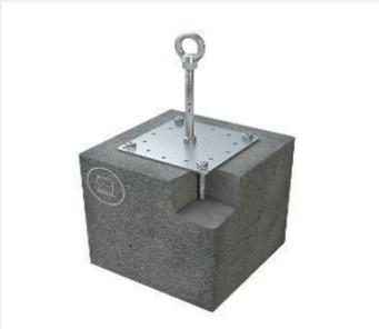
Lock X-B. Seine quadratische Grundplatte (200 x 200 mm) wird mit 4 Einschlagdübeln befestigt. Dabei genügt eine Einbautiefe von nur 65mm - ein echter Vorteil beim Thema thermische Betonkernaktivierung. Die in die Kühl- oder Heizdecken eingelassenen Rohre stehen einer Montage, die tiefe Bohrungen benötigt, oft entgegen.
