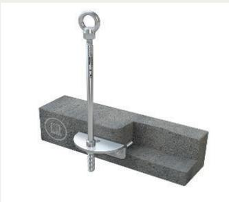
Der Anschlagpunkt Lock III-SEITL-65 zum Einbetonieren hat eine Winkelplatte für die seitliche Montage. Seine 2 Ankerstangen werden mit unserem Verbundmörtel im Untergrund befestigt. Der Anschlagpunkt sichert nach fachgerechter Montage bis zu 3 Ihrer Mitarbeiter gleichzeitig an Absturzkanten.
