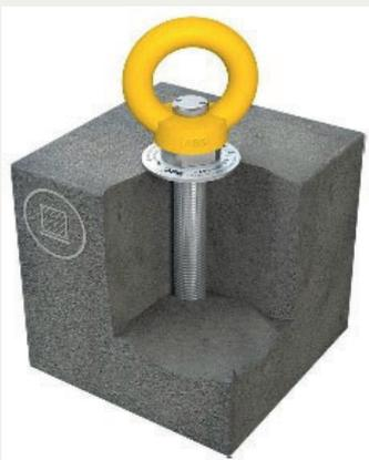
Der Lock III-R ist eine frei drehbare Edelstahl-Anschlageinrichtung für Wand, Boden, Fassade oder Montage über dem Kopf. Das 80 mm lange Gewinde (M16) des Lock III-R wird mit unserem Verbundmörtel direkt im Beton befestigt. Dank der drehbaren Öse bewegen Sie sich komfortabel um den zentralen Anschlagpunkt, ohne dass Ihr Verbindungsmittel sich verdreht oder Ihr Karabinerhaken verkantet.
