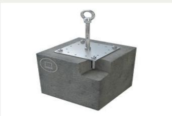
Mit einer Einbautiefe von nur 50mm ist der Anschlagpunkt Lock X-B-A bestens gerüstet für die Montage auf Gebäuden mit Betonkernaktivierung. Verwenden Sie diesen Anschlagpunkt, um die Rohre oder Kapillarrohrmaten der thermoaktiven Decken bei der Installation Ihrer Absturzsicherung nicht zu beeinträchtigen. Befestigt wird der Lock X-B-A mit 4 Ankerstangen, die mit Verbundmörtel im Beton verklebt werden. Eine quadratische Grundplatte (200x200mm) sorgt für zusätzliche Stabilität.
