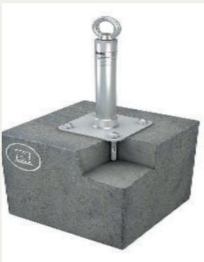
Eine starke Stütze für Betonuntergründe: Das ist der Einzelanschlagpunkt Lock X-SR-B mit Grundplatte (150 x 150 mm) und einem verschweißten Stützrohr ( $\varnothing$  42 mm). Sie befestigen den Anschlagpunkt einfach mit 4 Einschlagdübeln auf der Dachhaut oder an der Fassade. Die Einbautiefe beträgt nur 65 mm.
