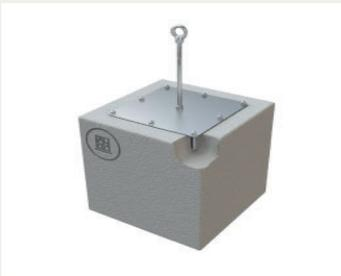
Der Anschlagpunkt Lock X-Y hält einiges aus: Seine Grundplatte (370 mm x 370 mm) wird mit 8 Ankerstangen und unserem speziellen Verbundmörtel im Betonuntergrund befestigt. Nach der Montage nutzen bis zu 3 Mitarbeiter das System gleichzeitig als zuverlässige Anschlagmöglichkeit auf Ytong (Porenbeton).
