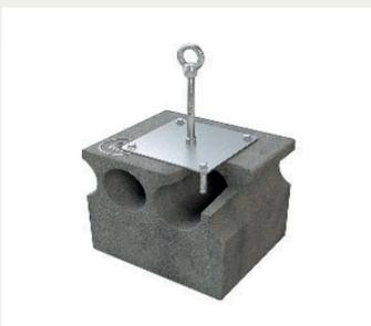
Anschlagpunkt  $\varnothing$ 16mm Lock X-HD ist für Beton-Hohldecken konzipiert und für 3 Personen zugelassen. Montage erfolgte mit 4 Edelstahlhohldielenanker (Spreizdübel). Grundplatte 220 x 220 mm
