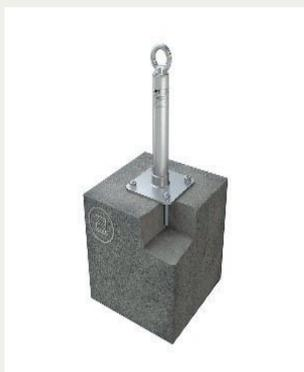
Der Anschlagpunkt Lock X-SR-B-A punktet mit seiner geringen Einbautiefe von nur 60 mm. Er wird mit 4 Ankerstangen und unserem optional erhältlichen Verbundmörtel im Beton befestigt. Der besonders robuste Edelstahl-Anschlagpunkt für Beton hat eine 150 mm x 150 mm große Grundplatte und ist mit einem verschweißten Stützrohr ausgestattet ( $\varnothing$  42 mm).
